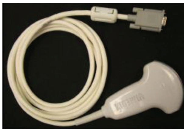
2. ábra Konvex fej. Transzabdominális vizsgálatához használjuk, a piezoelemek egy hengerpalást mentén helyezkednek el
