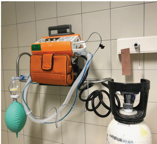
6. ábra Transzport lélegeztetőgép összeszerelve
