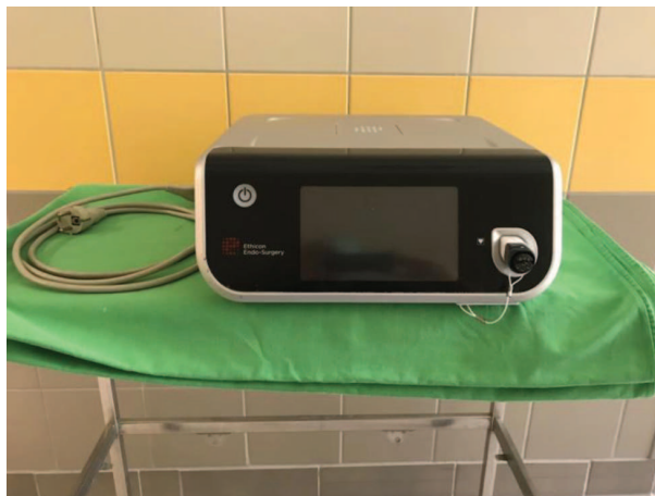
7. ábra Ultrahangos disszektor vezérlőegysége
