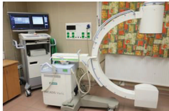
6. ábra C-karú röntgenátvilágító berendezés
