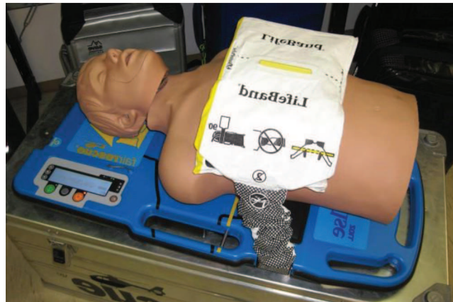
2. ábra AutoPulse mechanikus mellkaskomprimáló eszköz
